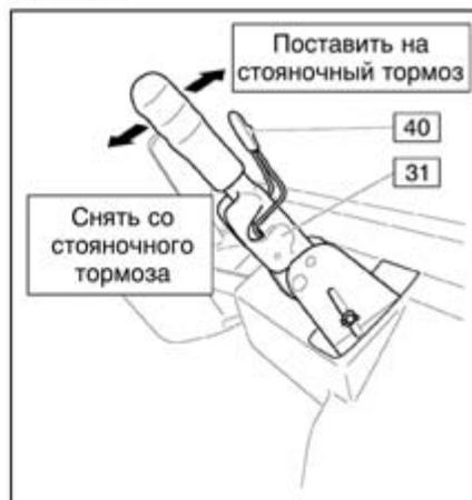
*Прежде чем оставить автопогрузчик, всегда устанавливайте его на стояночный тормоз и выключайте двигатель.*
