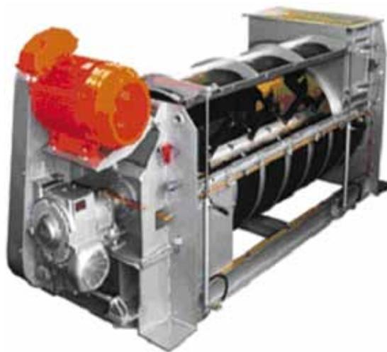
Рис.1. Одновальный смеситель непрерывного действия MFKG
