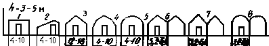
Рис. 10. Форма кровли однозвенных и блочных теплиц:
