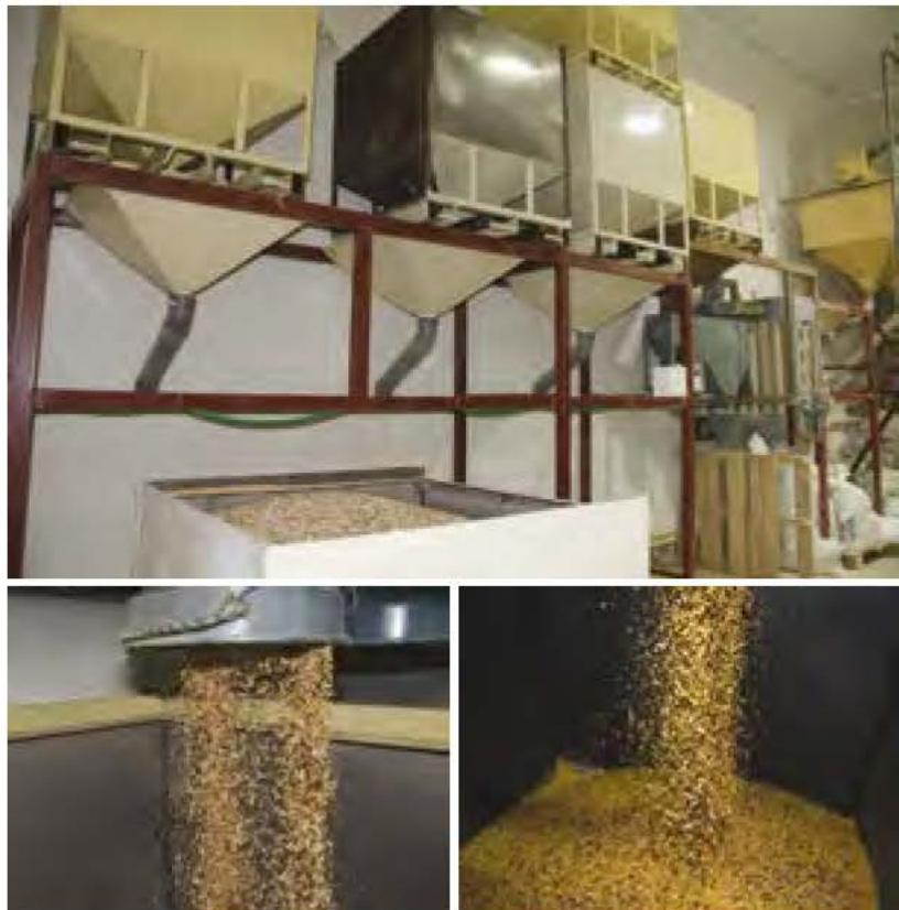
Автоматическая линия очистки зерна, в процессе которой провеиваются зерновые смеси, удаляется шелуха, грязь, пустые зерна
