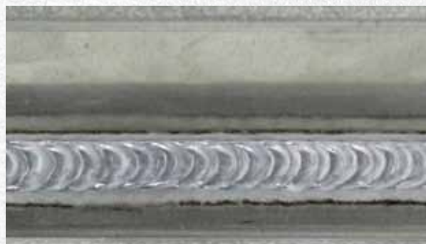
Угловой шов таврового соединения, лист толщиной 8 мм, AlMg, аргон Проволочный электрод диаметром 1,2 мм Равномерная чешуйчатость благодаря функции superPuls
