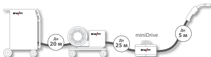
Пример системы: декомпактный сварочный аппарат + устройство подачи проволоки + miniDrive
