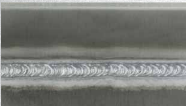
Угловой шов таврового соединения, лист толщиной 1 мм, AlMg, аргон Проволочный электрод диаметром 1,2 мм
