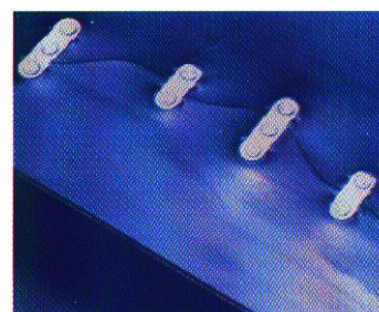
Рис.43 Зигзагообразный продольный сквозной порез конвейерной ленты
