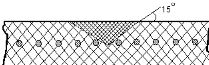
Рис. 53. Ремонт повреждения ленты с вырыванием троса
