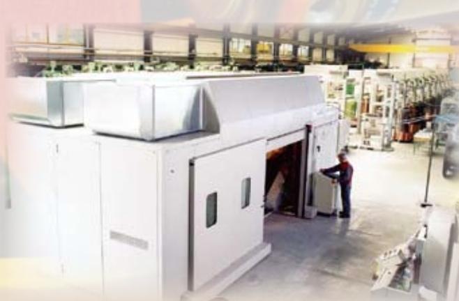
Отдающее устройство машины рассчитано на катушки (барабаны) диаметром до 630 мм, машина обеспечивает до 1000 скруток/мин. При скрутке 19 проволок длина машины может достигать 60 м. Загрузка катушек со скручиваемой проволокой производится с помощью крана или специального загрузочного устройства и занимает довольно много времени.
