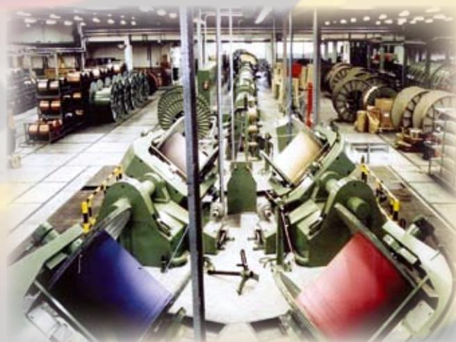
Вращающиеся отдающие устройства, на которых могут устанавливаться катушки (барабаны) диаметром 1250, 1600, 2000 мм и более, оснащены устройствами, обеспечивающими 100%-ную от-
