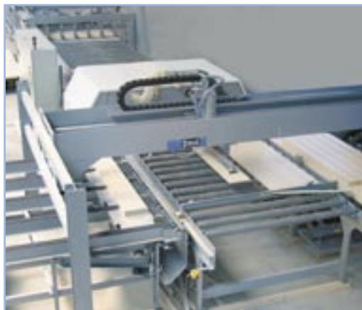
Рис. 34 Установка для укладки деталей в стопку с вакуум-порталом, установленна после многопила K34G/2200, с автоматической загрузкой
