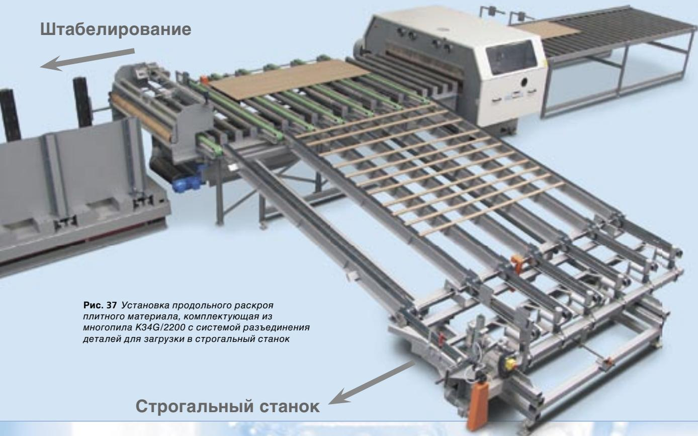
Рис. 37 Установка продольного раскроя плитного материала, комплектующая из многопила K34G/2200 с системой разъединения деталей для загрузки в строгальный станок
