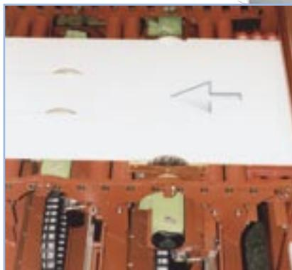
Рис. 31: Модель K34M с типичным расположением измельчителей и пильных агрегатов (здесь без верхних вальцев) Опцион: поставка с подрезным устройством
