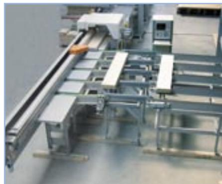
Рис. 35 Распил различных длин торцовочной установкой с ЧПУ-управлением
