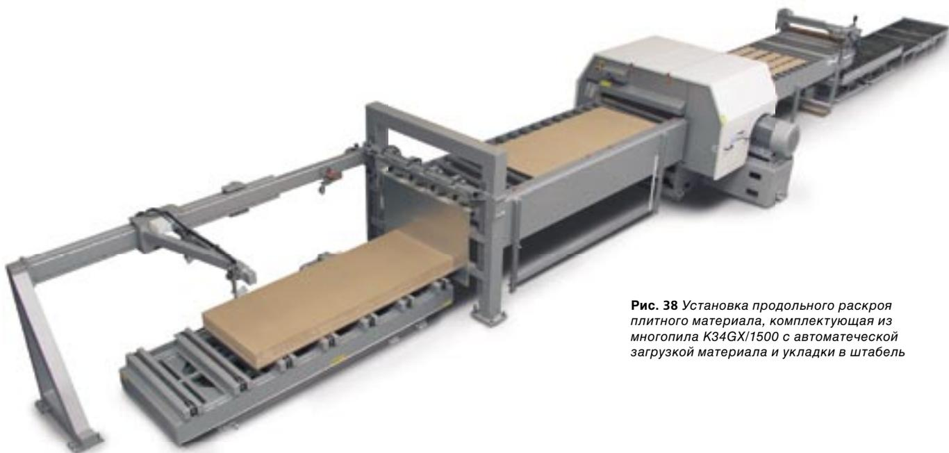
**Рис. 38** Установка продольного раскроя плитного материала, комплектующая из многопила K34GX/1500 с автоматической загрузкой материала и укладки в штабель
