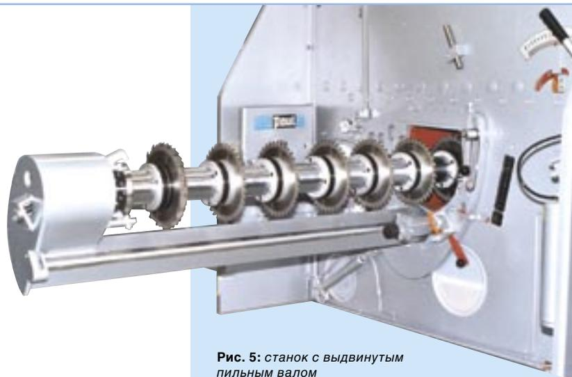
Рис. 5: станок с выдвинутым пильным валом
