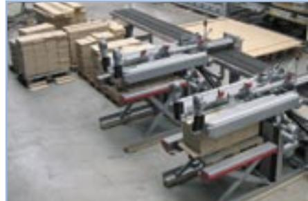
Рис. 36 Штабелирование на поддоны сортированных по длине деталей
