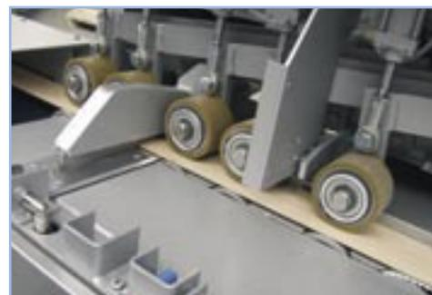
**Рис. 41** ... торцовочным узлом с ЧПУ-управлением интегрированным в линию посредством механизации
