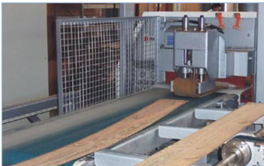
**Рис. 40** Установка распила облицованных ламель для производства паркета, комплектующая из многопила K34G/800 в особом исполнении с позиционирующим пильным диском и...
