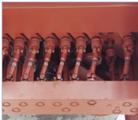
**Рис. 19:** *Привод подающих валиков с помощью карданных валов*
