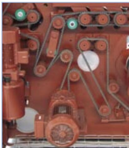
**Рис. 18:** *Цепной привод подачи*
