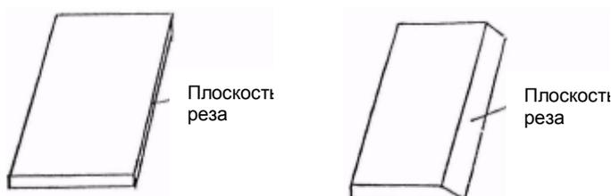
Распиловку под углом 45° выполняют после регулировки положения направляющей планки и наклона режущего диска на нужный угол.
