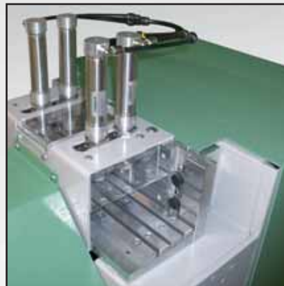
GLS 102 с вертикальным фиксирующим устройством и стандартными цулагами (включительно). GLS 102 z jednostką dociskową oraz z pionową i standardową prowadnicą
