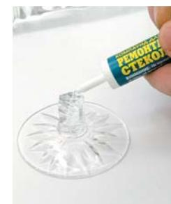
DD6585 схватывается при солнечном свете. Одна из поверхностей должна быть прозрачна, чтобы свет попадал на kleевой шов.
