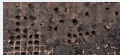
Низкооктановый бензин вызывает оплавление нейтрализатора
