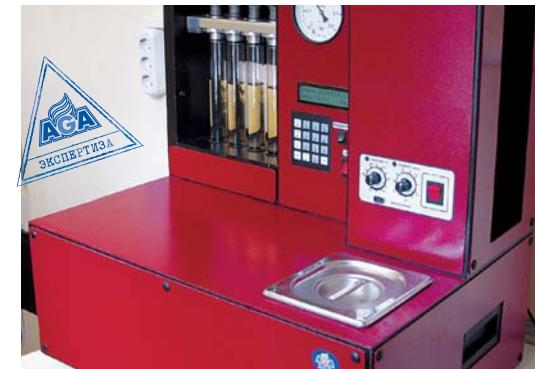
Рис. 1 Интегральная установка для тестирования моющих присадок к топливу
