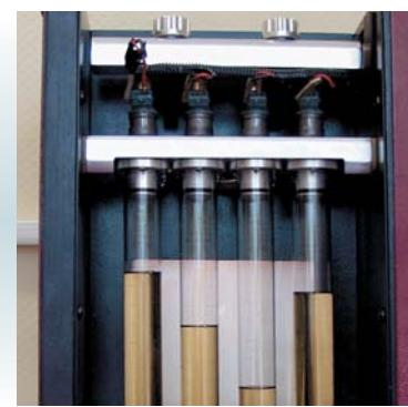
Рис. 2 Неравномерность работы форсунок двигателя ВАЗ-2111 с пробегом 18 000 км, вызванная загрязнениями
