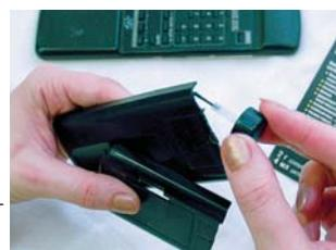
Рис. 2. При использовании цианакрилатного суперадгезива для пластика адгезив и активатор наносятся на одну и ту же поверхность
