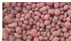
Пористый керамзит с выгорающими торфяными добавками
