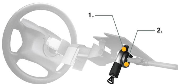
Замок состоит из муфты (2.), жёстко закрепляемой на рулевом валу, и стопора (1.), который фиксируется в муфте и препятствует повороту рулевого вала, упираясь в элементы автомобиля.
