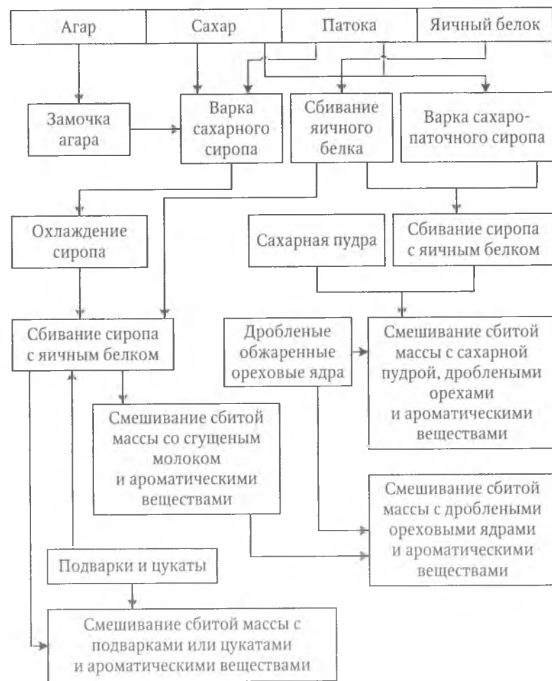
Технологическая схема приготовления сбивных конфетных масс
