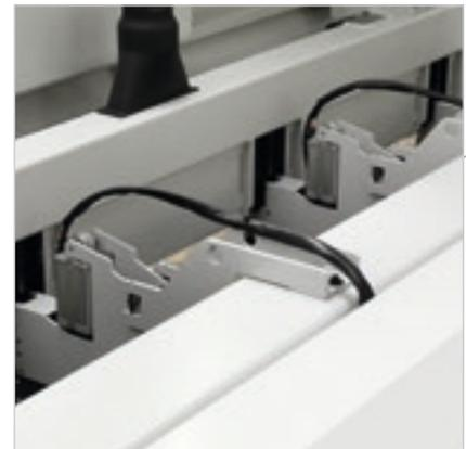
Равномерное и контролируемое давление на стопу раскраиваемых панелей обеспечивается прижимом в виде монолитной структуры.
