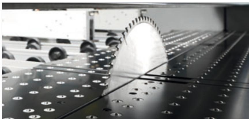
Максимальное качество готовой продукции благодаря ровному корпусу станины с воздушной подушкой для перемещения деликатных материалов. Это свойство позволяет, кроме того, поддерживать в постоянной чистоте плоскость рабочего стола в непосредственной близости от траектории пилы.
