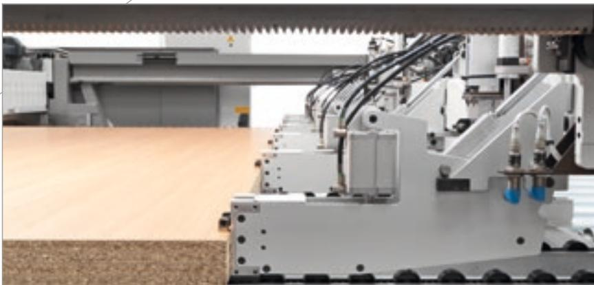
Зажимы, независимые и с а м о в ы р а в н и в а ю щ и е с я , обеспечивают надёжную фиксацию стопы панелей. Их специальная структура и логика станка позволяют производить полное выталкивание стоп раскроенных панелей за пределы линии распила, тем самым делая удобным как манипуляции с ними, так и выгрузку обрезков.
