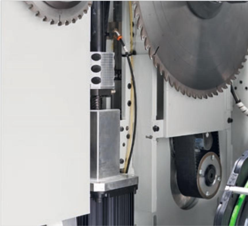
Подъем пилы управляется при помощи бесколлекторного двигателя и системы с ходовым винтом и бесконечной шариковой опорой. Эта система обеспечивает точную и быструю регулировку вылета пилы.
