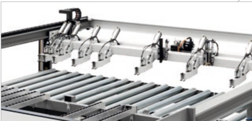
Аккуратное и быстрое позиционирование панелей с целью получения максимальной точности раскроя благодаря каретке толкателя, приводимой в действие бесколлекторным двигателем. Плоскость скольжения под толкателем оснащена бесприводными независимыми роликами во избежание царапания панелей с деликатными поверхностями.
