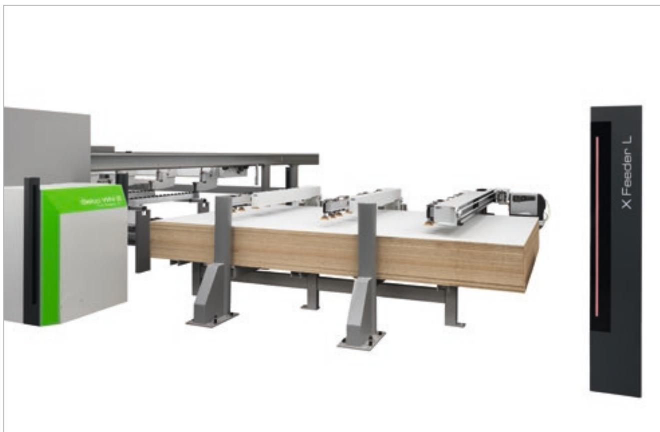
**Автоматическое определение положения панелей в позиции загрузки для корректного и точного нанесения этикеток.**
