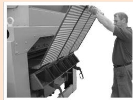
6. Протолкнуть до упора, закрыть крышку
