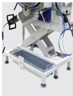
Включая регулируемый по высоте, прочный подъемный стол с резервуаром для сбора стружки
