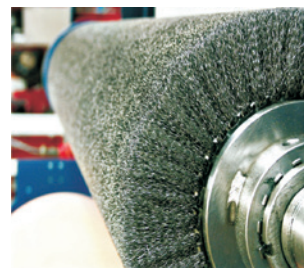
Притупление кромок (2 щетки из нержавеющей стали)
