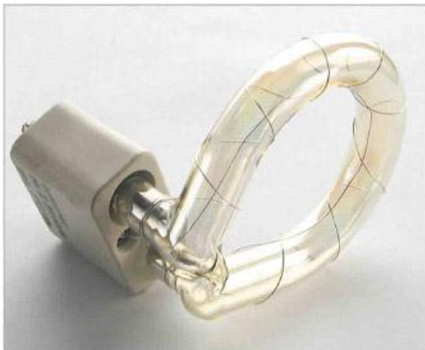
Кварцевые баллоны импульсных ламп пропускают свет с длиной волны от 155 нм до 4500 нм, стеклянные – от 290 нм до 3000 нм.
