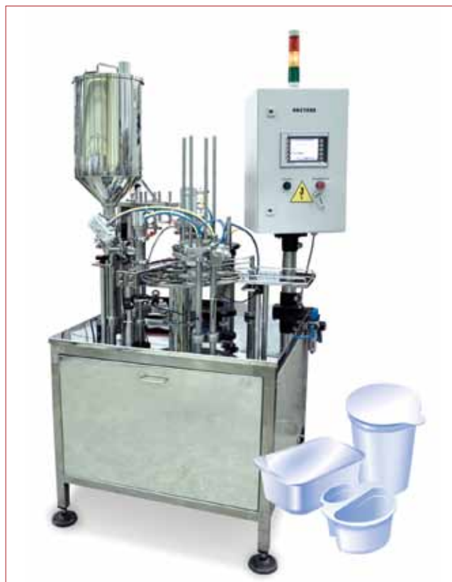
Роторный автомат «Пастпак Р серво» для фасовки в пластиковую тару
