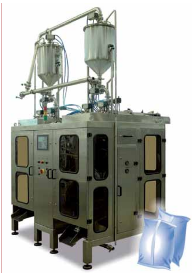
Вертикальный фасовочно-упаковочный автомат «Питпак МЖ2» для жидких и пастообразных продуктов
