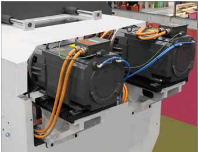
Передняя бабка с приводом от двух двигателей. Точность позиционирования оси C 0,001°. Headstock with twin motor. C axis accuracy 0,001°.
