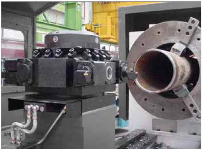
Диаметр отверстия шпинделя до 600мм. Main spindle bore up to 600 mm.
