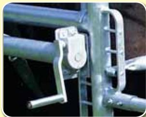
Удобный самостопающийся упиточный блок для натяжения и отпускания брюшных ремней
