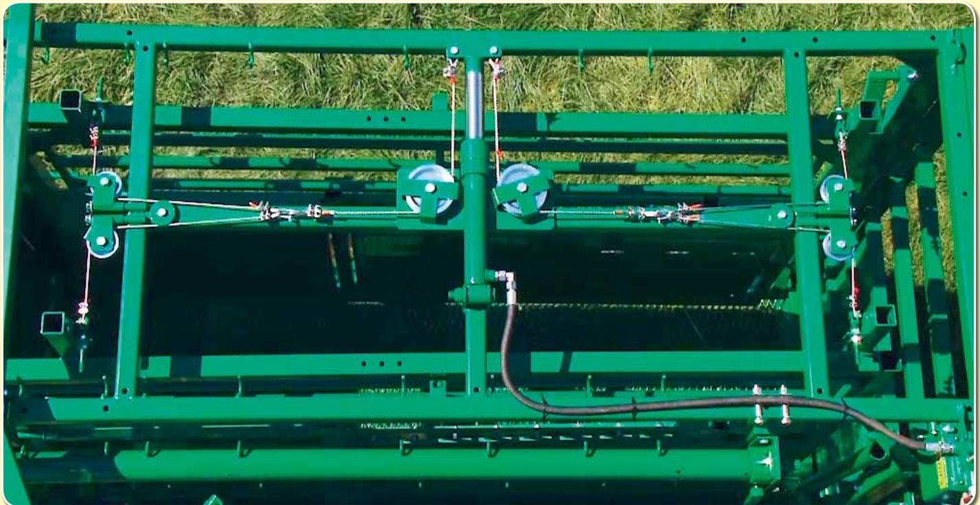
Комбинация из гидравлики и тросов обеспечивает легкую и надежную боковую фиксацию
