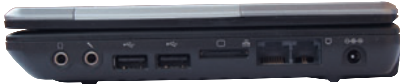
▲ Правая боковина S200N: аудиовыход, микрофонный вход, два порта USB 2.0, VGA-порт, LAN, модем, разъем источника питания.
