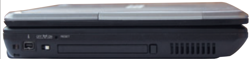
▲ Левая боковина S200N: порт FireWire, аппаратный выключатель Wi-Fi, слот PCMCIA.
