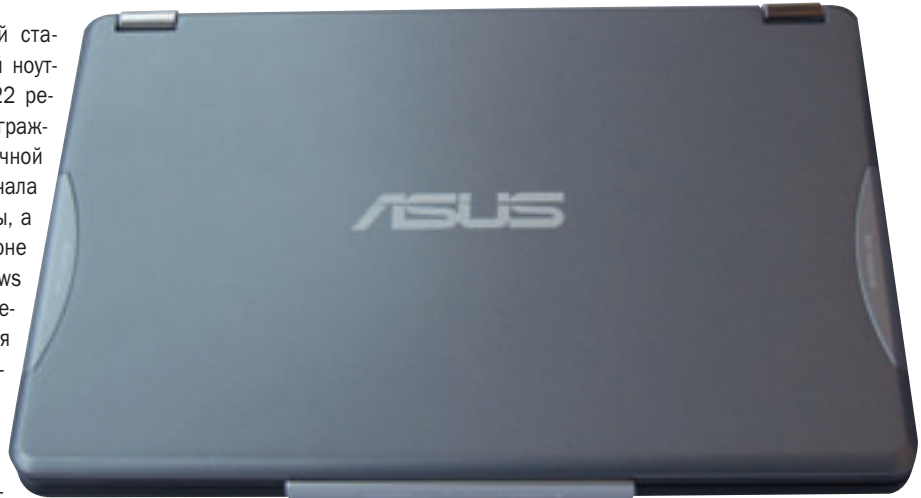
▲ Слева и справа на крышке S200N — антенны WLAN.
