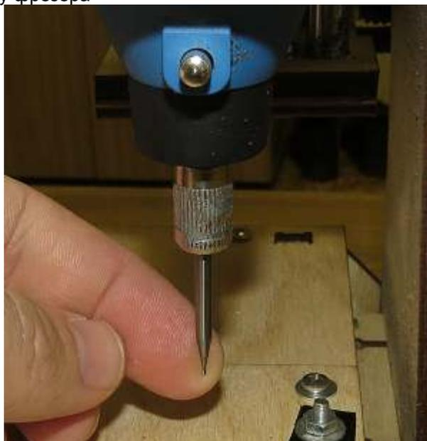
Придерживая фрезу, закручиваем нижнюю гайку до тех пор, пока фреза не станет выпадать из цанги, но может перемещаться в ней.
