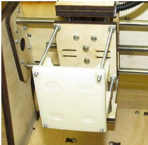
Установите фрезер и 2 дополнительные проставки. Прижмите основным креплением.
