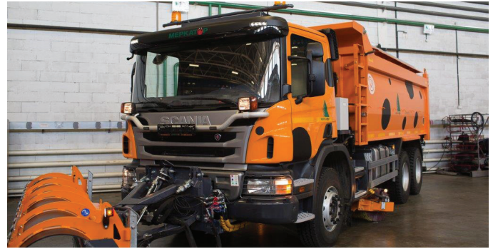
Автосамосвал Scania P400CB6x4HHZ с адаптации под монтаж спецоборудования
